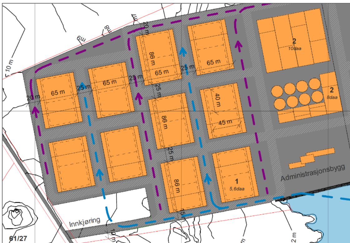
Figur 6-3. Illustrasjon med 10 bassengroper 86mx65m med to oppdrettskar per grop 45mx45m, til sammen 20 oppdrettskar.
